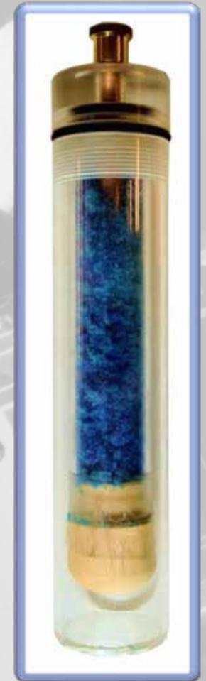
Anni '90: Elettrodi al  $\text{Cu}/\text{CuSO}_4$  di vari formati e tipologie.
